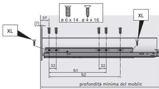
**Dimensione di ingombro con Silent System / Push to open Silent**
