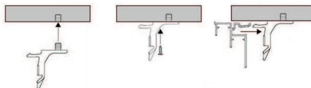
**Montaggio del binario superiore con attacco a clip**
