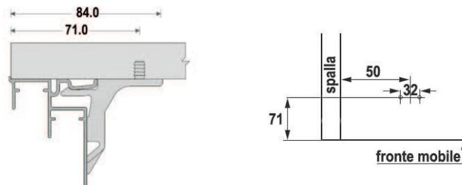
**Montaggio del binario inferiore con attacco a clip**
