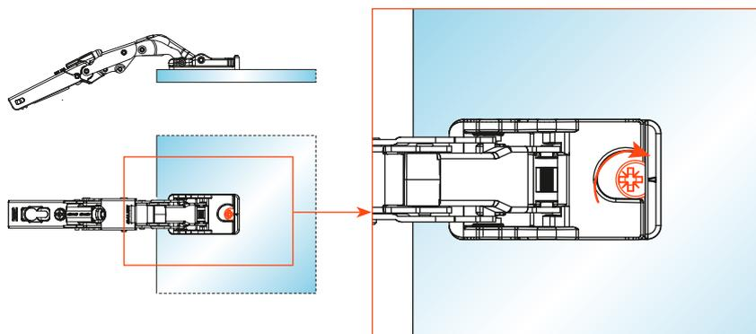
**3)** Ruotare l'eccentrico di fissaggio.
