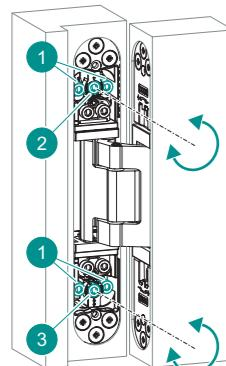
**Höhenverstellung / Height adjustment / Réglage vertical / Regulación de altura:**
